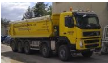
VOLVO 10x6 Trojstranný sklápač 15m 3 , nosnosť 22t Využitie: Preprava syp-
