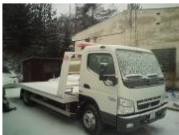
Mitsubishi FUSO Odťahová služba s navijákom Využitie: Prepra- va havarovaných vozidiel, prepra- va malých sta-
