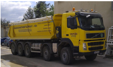
VOLVO 10x6 Trojstranný sklápač 15m 3 , nosnosť 22t Využitie: Preprava syp-
