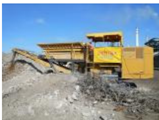
RESTA DCJ 900x600 Čelustový drvič s otvorom drviča 900x600
