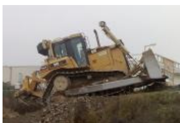
CAT D6R XL II. series Pásový dózer, rippre, objem radlice 5,6m 3 , váha 20t.
