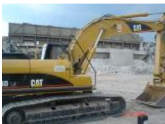
CAT 324D LN Pásové rýpadlo, dosah 9m, lyžica 1,73m 3 , váha 25t.
