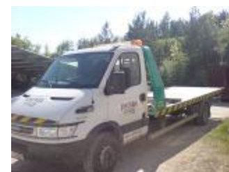
IVECO Daily Odťahová služba s hydraulickou plošinou. Využitie: Preprava havarovaných vozidiel, preprava malých stavebných mechanizmov, navijak.
