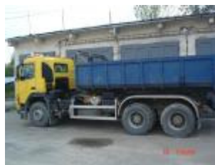
VOLVO 6x4 (2ks) Kontajnerový naťahovač, príves. Kontajnery 15m 3 a 30m 3 .
