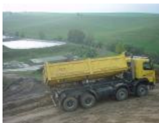
VOLVO 8x6 Trojstranný sklápač 15m 3 , nosnosť 26t Využitie: Preprava sypkých materiálov, dovoz a
