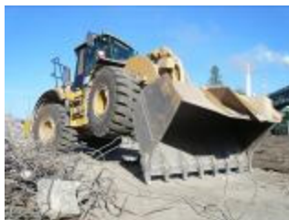
CAT 950H Čelný kolesový nakladač, objem lopaty 3m 3 , váha 18t.
