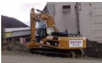
CAT 330D L Pásové rýpadlo, dosah 10,5m, lyžica 2,03m 3 , váha 35t.
