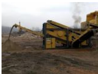
RESTA TK7 Kontajnerový triedič, dvojsitný, tri frakcie podľa požiadaviek. Kompaktné rozmery,
