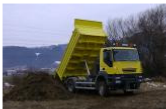
IVECO Trakker 4x4 Trojstranný sklápač, nosnosť 10t Využitie: Preprava sypkých materiálov, údržba komunikácií, skrúpanie vodou.
