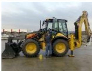
CAT 444E Kolesové rýpadlo-nakladač, predná lyžica 1,3m 3
