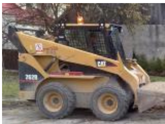
CAT 262B Šmykom riadený nakladač Príslušenstvo: Zametacia metla Paletizačné vidly Snehová fréza
